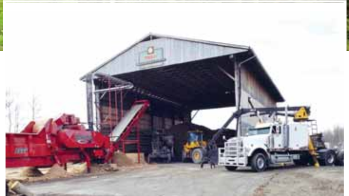
Trèd'si possède toutes les machineries nécessaires pour mener à bien la transformation du bois, comme ce broyeur Rotochopper. Autant que possible, l'entreprise fait l'acquisition d'équipement non polluant (qui fonctionnent à l'électricité).
